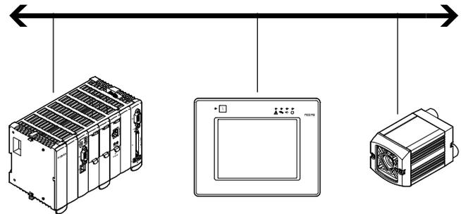
A través de la interfaz Ethernet, pueden cambiarse con EasyIP, Telnet Modbus TCP todos los parámetros y leerse los resultados del control y los valores característicos.
