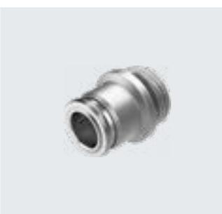
Racor rápido roscado de acero inoxidable. Máxima resistencia a la corrosión CRC 4 y a sustancias químicas. Para aplicaciones neumáticas con un margen de temperatura de hasta 150 °C y un margen de presión de hasta 16 bar. Diámetro exterior de los tubos flexibles de 4, 6, 8, 10 y 12 mm con rosca de conexión M5, M7 y G1/8... G1/2.
