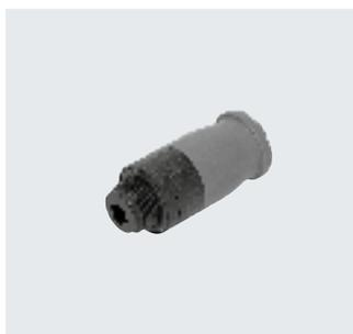
Racor de plástico para una instalación sencilla gracias al manejo con una sola mano. Resistente a la hidrólisis, conforme con las especificaciones de la FDA y de fácil limpieza. Para aplicaciones neumáticas con un margen de temperatura de hasta 60 °C y un margen de presión de hasta 10 bar. Diámetro exterior del tubo flexible de 6 mm con rosca de conexión G1/8.
