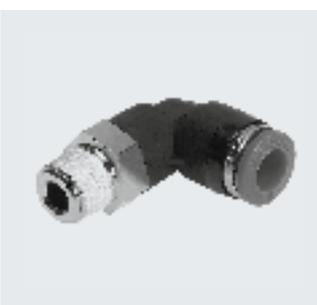
Gran variedad de racores rápidos roscados para aplicaciones neumáticas con un margen de temperatura de hasta 80 °C y un margen de presión de hasta 14 bar. Diámetro exterior de los tubos flexibles de 4, 6, 8, 10, 12, 16 y 22 mm con rosca de conexión de R1/8... R1/2 y G1/8 ... G3/4.
