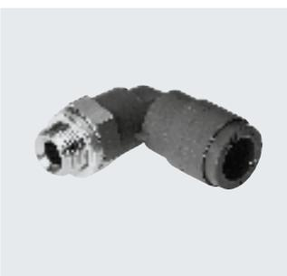
Racor rápido roscado ignífugo para la utilización en zonas con peligro de incendio, por ejemplo, en equipos de soldadura en la industria automovilística o en el sector de la construcción. Para aplicaciones neumáticas con un margen de temperatura de hasta 60 °C y un margen de presión de hasta 10 bar. Diámetro exterior de los tubos flexibles de 4, 6, 8, 10 y 12 mm con rosca de conexión R1/8... R1/2 y G1/8 ... G1/2.
