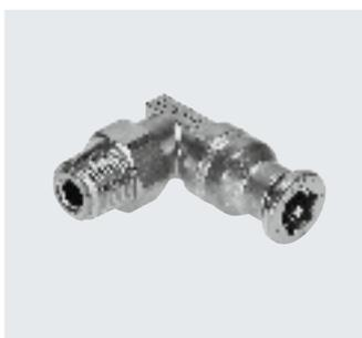
Racor rápido roscado de acero inoxidable. Máxima resistencia a la corrosión CRC 4 y a sustancias químicas; certificado para la industria alimentaria y del envasado. Para aplicaciones neumáticas con un margen de temperatura de hasta 120 °C y un margen de presión de hasta 10 bar. Diámetro exterior de los tubos flexibles de 4, 6, 8, 10, 12 y 16 mm con rosca de conexión M5 y R1/8... R1/2.
