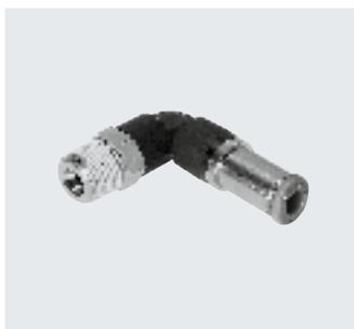
El racor rápido roscado bloquea el flujo de aire después de soltarse el tubo flexible. Para aplicaciones neumáticas con un margen de temperatura de hasta 60 °C y un margen de presión de hasta 14 bar.
