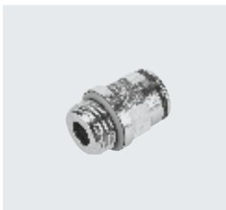
Racor metálico de latón, niquelado químico. Resistencia a la corrosión elevada CRC 3 y a las sustancias químicas. Para aplicaciones neumáticas con un margen de temperatura de hasta 150 °C y un margen de presión de hasta 20 bar. Diámetro exterior de los tubos flexibles de 4, 6, 8, 10, 12 y 14 mm con rosca de conexión M5, M7 y G1/8... G1/2.
