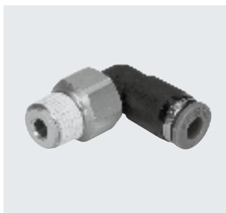
Racor rápido roscado con junta basculante, orientable 360°. El cojinete de bolas permite movimientos giratorios de hasta 500 rpm. Para aplicaciones neumáticas con un margen de temperatura de hasta 60 °C y un margen de presión de hasta 14 bar.
