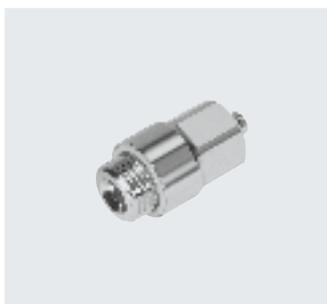
Racor de acero inoxidable para el uso en áreas expuestas a limpieza intensiva. Máxima clase de resistencia a la corrosión CRC 4. Para aplicaciones neumáticas con un margen de temperatura de hasta 120 °C y un margen de presión de hasta 12 bar.
