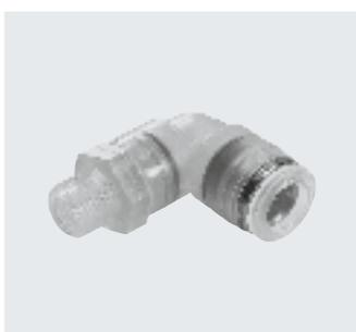
Racor de polipropileno, ideal para aplicaciones bajo condiciones ambientales extremas. Para aplicaciones neumáticas con un margen de temperatura de hasta 60 °C y un margen de presión de hasta 10 bar. Diámetro exterior de los tubos flexibles de 4, 6, 8, 10 y 12 mm con rosca de conexión de R1/8... R1/2.
