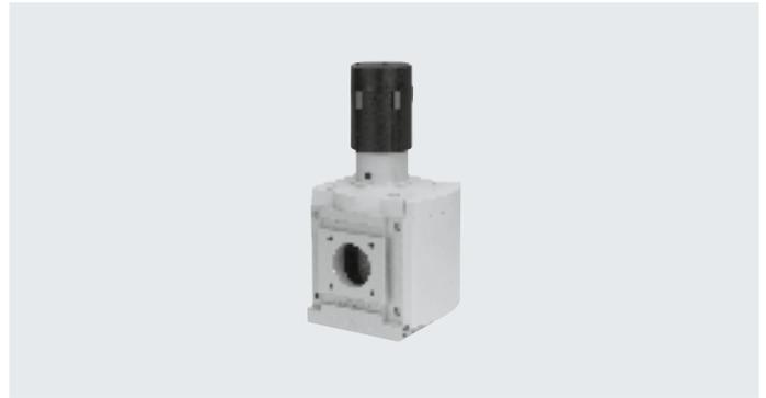
Este regulador de presión mantiene constante la presión de salida p2 independientemente de las oscilaciones de la presión y del consumo de aire. Dentro del margen de regulación de la presión es posible ajustar la presión de salida p2 manualmente con el botón giratorio o neumáticamente mediante una presión de mando p12 con un regulador piloto externo. Al desconectar la presión de funcionamiento, se descarga la presión de salida p2 a través de la conexión 3 (descarga de aire secundaria).
