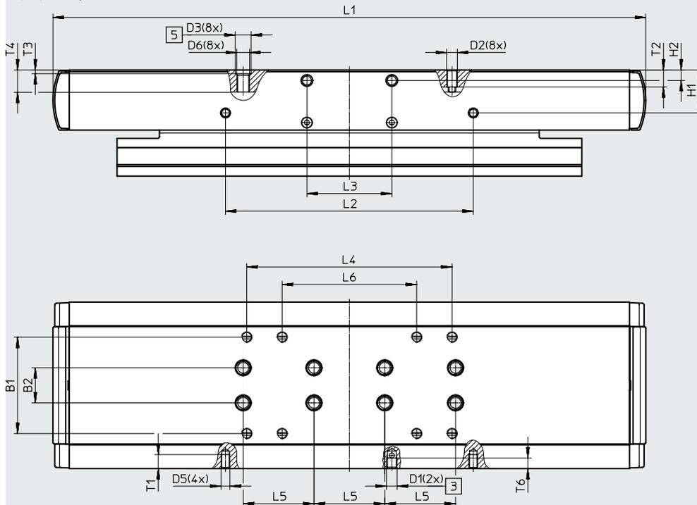
[3] Conexiones de lubricación
