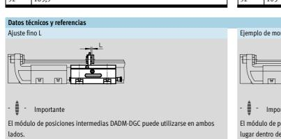
Si se utiliza un módulo de posiciones intermedias, deberá montarse adicionalmente un elemento de sujeción DADP-DGC para amortiguadores y un tope KYC.
