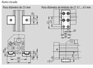
1 Posición indistinta del soporte central en la zona del tubo perfilado. Tener en cuenta la distancia
