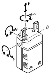
Las fuerzas y momentos admisibles indicados hacen referencia a una mordaza. Los valores indicados incluyen el brazo de palanca, fuerzas adicionales debidas al peso de la pieza u ocasionadas por dedos de sujeción externos y, además, las fuerzas ocasionadas por la aceleración durante la ejecución del movimiento. Al efectuar el cálculo de los momentos debe tenerse en cuenta el punto O del sistema de coordenadas (guía de las mordazas).
