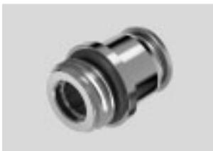
Racor rápido roscado de acero inoxidable. Máxima resistencia a la corrosión (CRC 4) y a sustancias químicas. Para aplicaciones neumáticas con temperaturas de hasta 150 °C y presiones de hasta 16 bar. Diámetro exterior de los tubos flexibles de 4, 6, 8, 10 y 12 mm con rosca de conexión M5, M7 y G1/8 ... G1/2.
