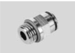
Racor metálico de latón, niquelado químico. Resistencia elevada a la corrosión (CRC 3) y a las sustancias químicas. Para aplicaciones neumáticas con temperaturas de hasta 150 °C y presiones de hasta 20 bar. Diámetro exterior de los tubos flexibles de 4, 6, 8, 10 y 12 y 14 mm con rosca de conexión M5, M7 y G1/8 ... G1/2.
