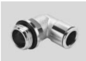
Racores metálicos a un precio atractivo para aplicaciones neumáticas con temperaturas de hasta 70 °C y presiones de hasta 16 bar. Diámetro exterior de los tubos flexibles de 3, 4, 6, 8, 10 y 12 y 14 mm con rosca de conexión M5, M7 y G1/8 ... G1/2.
