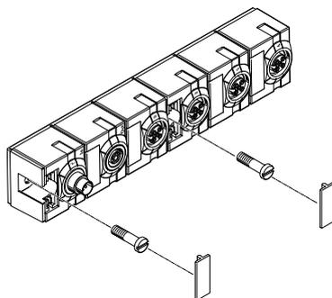
Los módulos CP pueden montarse en prácticamente cualquier superficie plana utilizando los taladros de montaje disponibles (con tornillos con diámetros de hasta 4 mm).
