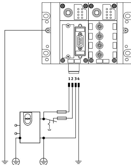
La utilización de equipos descentralizados conectados al bus de campo, especialmente con alto grado de protección para el montaje directo en la máquina, exige un sistema versátil de alimentación eléctrica. El terminal CPX permite conectar cualquier potencial a través de una conexión.
