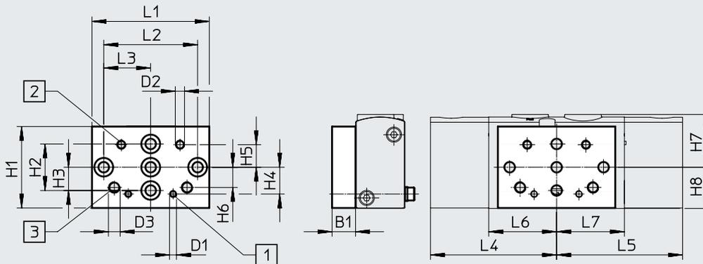
[1] Befestigungsbohrung für Baugröße 20
