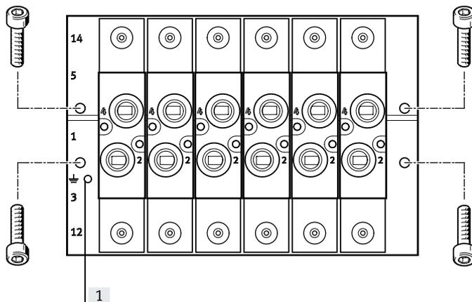
Robuste Wandmontage des Anschlussblocks mittels vier Durchgangsbohrungen.
