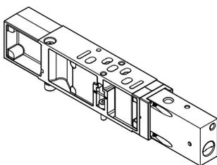
Mit einem Schalter ausgestattet über den die Druckversorgung abgesperrt werden kann. Damit kann ein Wege-Magnetventil oder eine nachfolgende Höhenverkeftungsplatte ausgetauscht werden ohne die Gesamtluftversorgung abzuschalten.
