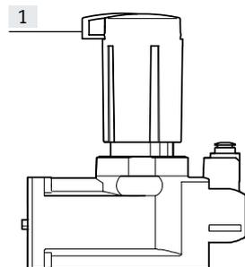
Nach erfolgter Druckeinstellung kann der Drehknopf gegen unbefugte Betätigung gesichert werden. Dazu wird das blaue Verriegelungs-Element herausgedrückt und mit einem Vorhängeschloss gesichert. Der Drehknopf ist nun fixiert und kann jetzt nicht mehr bewegt werden.
