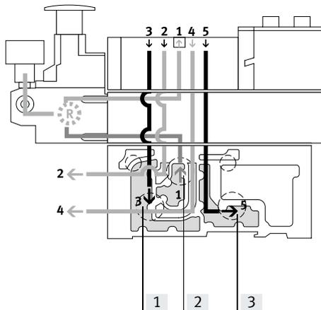
Dieser Druckregler regelt den Druck vor dem Ventil im Kanal 1. Dadurch haben die Kanäle 2 und 4 den gleichen geregelten Druck.
