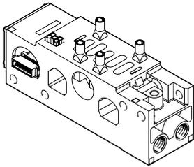
Die Adaption auf Baubreite 65 mm ISO Größe 3 basiert auf einem modularen System, bestehend aus Verkettungsplatten und Ventilen. Die Verkettungsplatten enthalten eine Kanaldichtung und eine elektrische Verkettung, sind miteinander verschraubt und bilden so das Trägersystem für die Ventile.
