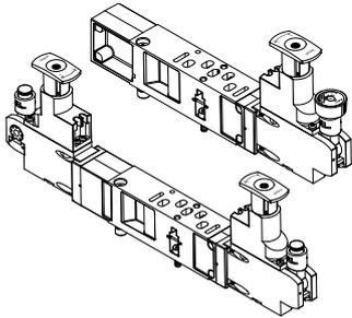
Für die Beeinflussung der Kraft des angesteuerten Aktuators kann zwischen Grundplatte (Verkettungsplatte) und Ventil ein einstellbares Druckregelventil eingebaut werden.
