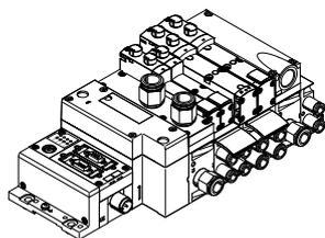
Die Kommunikationsverbindung zu einer übergeordneten SPS übernimmt ein integrierter Feldbusknoten. Somit lässt sich eine platzsparende Lösung in Pneumatik und Elektronik realisieren. Ventilinseln mit Feldbusanschlüssen aus dem CPX-System können mit bis zu 16 Verkettungsplatten ausgeführt werden. Bei 2 Magnetspulen pro Anschluss können somit bis zu 32 Magnetspulen angesteuert werden.
