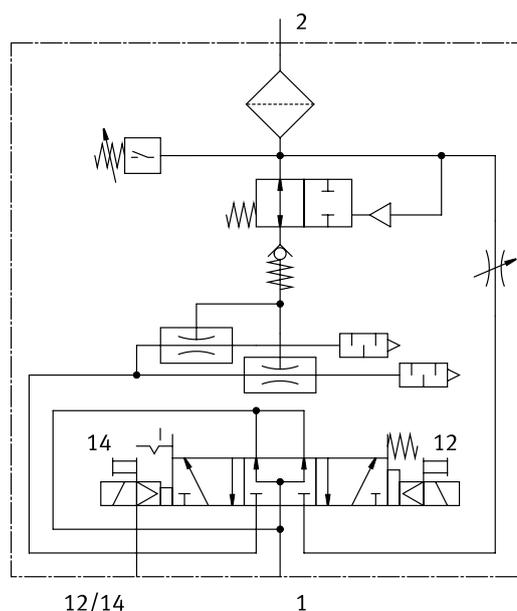
Die Versorgung der Vakuumsaugdüse erfolgt intern über Kanal 1 der Verkettungsplatte der Ventilinsel.
