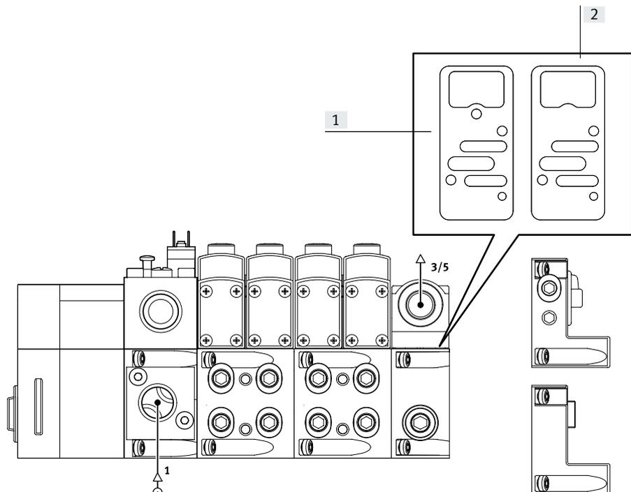
[1] Dichtung für Steuerluftversorgung intern
