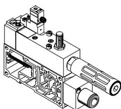
Das Druckaufbauventil wird unabhängig vom Multipol-, AS-Interface- oder Feldbus-Anschluss separat elektrisch angesteuert mit viereckigem Stecker Form C nach EN 175301803, oder optional mit einem M12Adapter.
