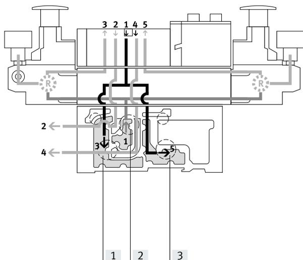
Bei diesem Druckregler wird die Arbeitsluft (Kanal 1) aufgesplittet und direkt auf beide Druckregler geleitet. Die jeweils geregelte Arbeitsluft steht in den Kanälen 3 und 5 am Ventil an. Das Ventil wird somit reversibel betrieben. Das heißt:
