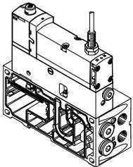
Das Steuerluft-Schaltventil ist eine Kombination aus einem 5/2 Wege-Magnetventil mit Schaltstellungsabfrage und der Zwischenplatte VABF-S4-...-S. Es ermöglicht das überprüfbare Ein- und Ausschalten (Sensorabfrage) der Steuerluftversorgung von Kanal 1 nach 14 für die gesamte Druckzone, bzw. Ventilinsel.
