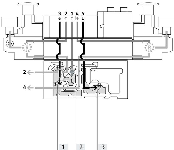
Dieser Druckregler regelt den Druck in den Kanälen 2 und 4 nachdem das Druckmedium durch das Ventil geströmt ist. Beim Entlüftungsvorgang wird im Ventil über den Druckregler von Kanal 2 nach Kanal 3 und von Kanal 4 nach Kanal 5 entlüftet.
