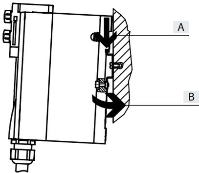
Die Ventilinsel VTSA/VTSA-F/VTSA-F-CB wird in die Hutschiene eingehängt (siehe Pfeil A).
