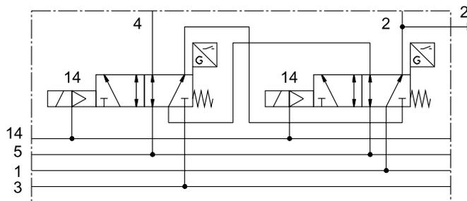
Beim Steuerblock mit Sicherheitsfunktion VOFA-B26-T52-... für die Ventilinsel werden zwei 5/2-Wege-Magnetventile, Baubreite 26 mm, mit der Zwischenplatte als Höhenverkettung pneumatisch zweikanalig verkettet (Ausgang 2 ist parallel, Ausgang 4 ist in Reihe geschaltet).
