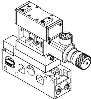
Auf jedem Ventilplatz ISO Größe 3 können zwischen Grundplatte (Verkettungsplatte) und Ventil weitere Baueinheiten eingefügt werden.
