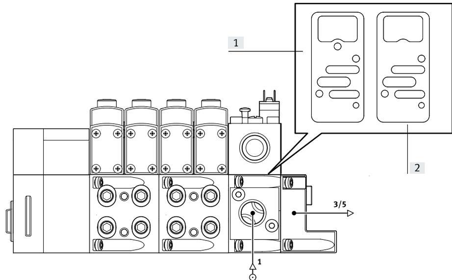
[1] Dichtung für Steuerluftversorgung intern
