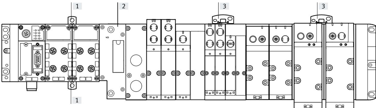
[1] Wand-Zusatzbefestigung für CPX-Polymer
