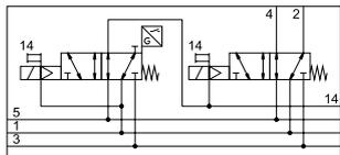
Ursprünglich wird die Funktion zum Abschalten der Steuerluft durch die Kombination der Zwischenplatte Typ VABF-S4-...-S mit dem monostabilen 5/2 Wege-Magnetventil Typ VSVA-B-M52-MZD-...-1T1L-APX-0.5 erzielt.
