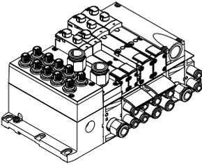
Die Signalansteuerung von der Steuerung zur Ventilinsel erfolgt über Einzelanschlusskabel.
