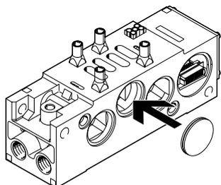
Unterschiedliche Versorgungsdrücke im Bereich der Ventile Baubreite 65 mm sind durch den Einbau von Verschluss-scheiben zwischen zwei Anschlussblöcken möglich. Dabei ist zu beachten, dass die Verschluss-scheibe von rechts in die Verkettungsplatte eingelegt wird.
