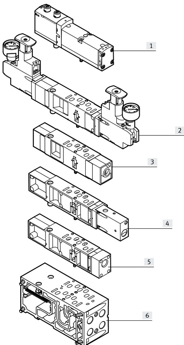
Auf Ventilplätzen mit Höhenverkettung wird folgende Komponenten-Reihenfolge empfohlen:
