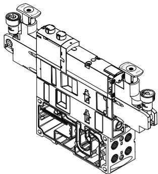
Auf jedem Ventilplatz können zwischen Grundplatte (Verkettungsplatte) und Ventil weitere Funktionseinheiten eingefügt werden.
