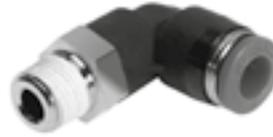
Breite Auswahl an Steckverschraubungen für Pneumatikanwendungen mit einem Temperaturbereich bis 80 °C und einem Druckbereich bis 14 bar. Schlauch-Außen- $\varnothing$  4, 6, 8, 10, 12, 16 und 22 mm mit Anschlussgewinde von R1/8 ... R1/2 und G1/8 ... G3/4.
