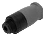
Kunststoffverschraubung für einfache Installation durch Einhandbedienung. Hydrolysebeständig, FDA konform und reinigungsfreundlich. Für Pneumatikanwendungen mit einem Temperaturbereich bis 60 °C und einem Druckbereich bis 10 bar.
