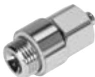
Edelstahlverschraubung für den Einsatz in reinigungsintensiven Bereichen. Höchste Korrosionsbeständigkeit KBK4. Für Pneumatikanwendungen mit einem Temperaturbereich bis 120 °C und einem Druckbereich bis 12 bar.
