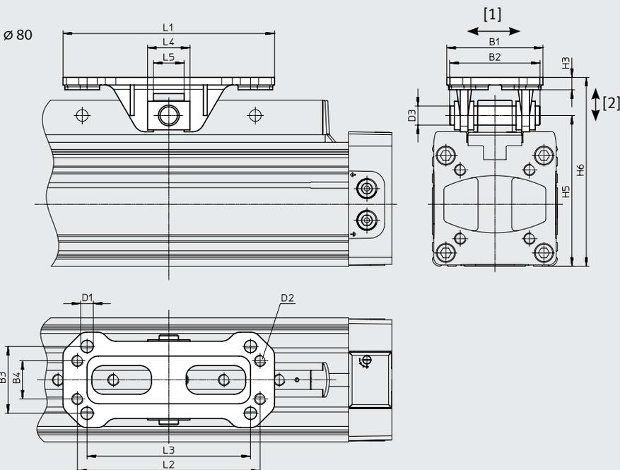
Der Mitnehmer DARD-S hat die gleiche Schnittstelle wie der Mitnehmer FKP beim Linearantrieb DGP. In servopneumatischen Systemen Mitnehmer DARD-M verwenden.
