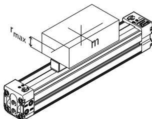
Die Dämpfung in den Endlagen ist so einzustellen, dass ein stoßfreier Betrieb gewährleistet ist. Liegen die Betriebsbedingungen außerhalb des zulässigen Bereiches, ist die bewegte Masse durch geeignete Vorrichtungen (externe Stoßdämpfer), möglichst im Massenschwerpunkt, abzufangen.
