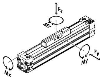
Wirken gleichzeitig mehrere der unten genannten Kräfte und Momente auf den Antrieb, müssen neben den aufgeführten Maximalbelastungen folgende Gleichungen erfüllt werden:
