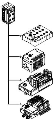
Die Elektrik-Anschaltung CPX CTELMaster erstellt die Verbindung zu Modulen mit I-Port Schnittstelle (Device) der CTEL/CTEU-Familie. Die E/A-Daten der angeschlossenen Devices werden an den angeschlossenen CPX-Busknotten und somit über Feldbus an die übergeordnete Steuerung übertragen. Über entsprechende M12-Schnittstellen können maximal 4 Devices an einen CPX CTELMaster angeschlossen werden.
