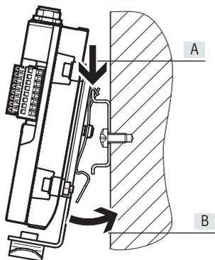
H型导轨安装件 VAME-V3-H 的组成包括一个安装支架和一个夹子:
