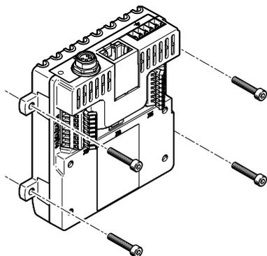
通过四个通孔牢固地壁挂式安装阀控制模块。
