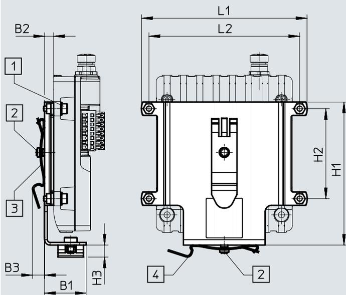
[1] 直径 3.2，用于 M3 内六角螺丝    [2] 直径 4.2，用于 M4 内六角螺丝    [3] 后侧夹子的安装位置    [4] 底部夹子安装位置
