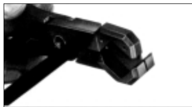
Corte de tubo metálico.
