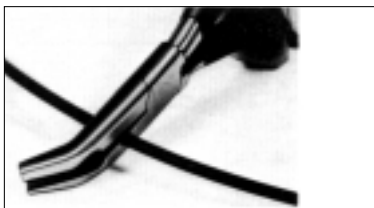
Corte o tubo no comprimento desejado.
