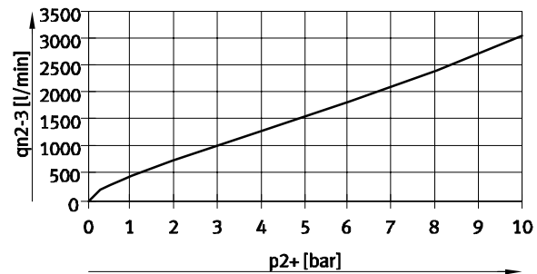
出力圧力 p_2 時の2→3の流量 q_n
