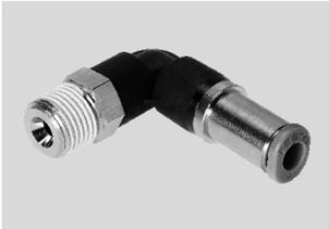
Le raccord enfichable bloque le flux d'air lorsque le tuyau est retiré. Pour les applications pneumatiques avec une plage de température allant jusqu'à 60 °C et une plage de pression allant jusqu'à 14 bar.
