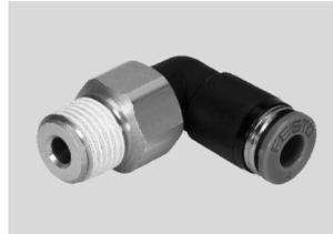
Raccord enfichable orientable, rotation à 360° Le roulement à billes assure des mouvements de rotation pour l'application, jusqu'à 500 U/min max. Pour les applications pneumatiques avec une plage de température allant jusqu'à 60 °C et une plage de pression allant jusqu'à 14 bar.
