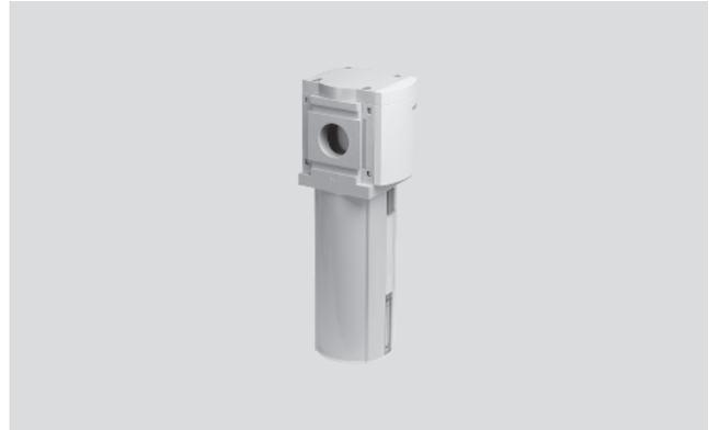
Le filtre fritté avec cyclone de séparation permet de débarrasser l'air comprimé de toutes impuretés, particules, moisissures, rouille et eau de condensation. Les cartouches filtrantes sont interchangeables.
