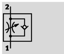
Limiteur de débit unidirectionnel à l'échappement
