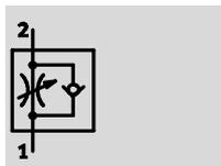
Limiteur de débit unidirectionnel à l'échappement
