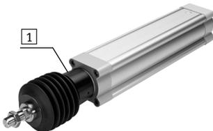
Le soufflet protège la tige de piston, le joint et le palier des effets d'une grande variété de fluides, augmentant ainsi sa durée de vie.
