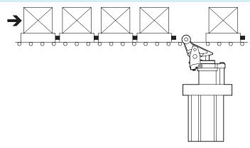
Pour une vitesse de transport de 15 m/min, pour le DFST-50, la masse maximale admissible est de 320 kg. Comme la masse totale des 4 palettes qui avancent sur le vérin bloqueur est de 400 kg, pour séparer, il faut choisir le vérin bloqueur de la taille supérieure suivante.
