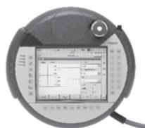
Le terminal de commande CDSA possède un interrupteur d'arrêt d'urgence ainsi qu'un commutateur d'activation à 3 niveaux. Ces deux dispositifs sont exécutés sur 2 voies et sont prêts à être intégrés au circuit de sécurité du client. Le commutateur d'activation sert à l'approbation de la puissance en mode réglage. Le CDSA dispose, en plus d'un ordinateur embarqué et d'un boîtier ergonomique, d'un écran tactile couleur sur lequel des actions peuvent être lancées.
