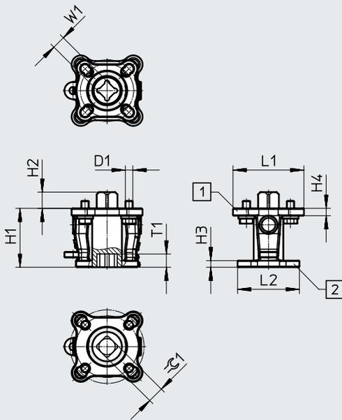
[1] Conexión 1, salida de accionamiento
