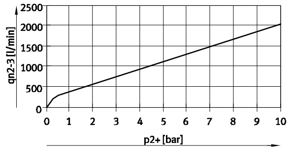
Caudal q_n de 2 → 3 en de la presión de salida p_2
