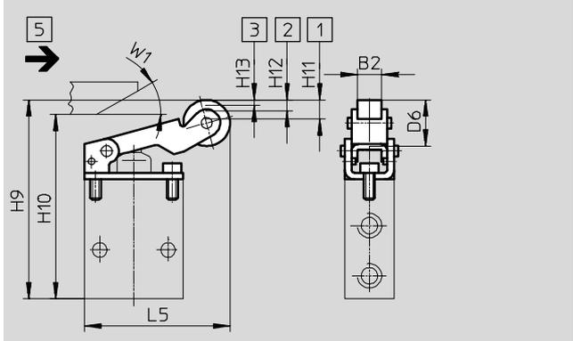
Palanca con rodillo de accionamiento basculante AL-01 para válvula de leva V/O-3-1/8
