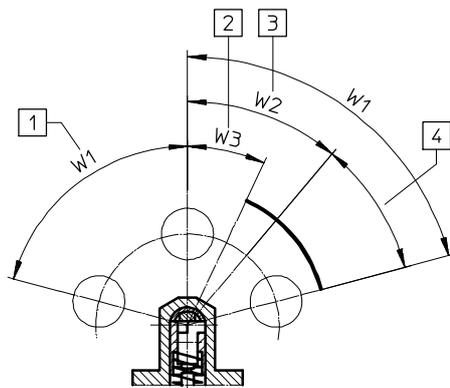
Partes 1 y 2 giradas en 90° a lo largo del eje longitudinal
