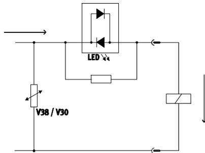
Cada bobina tiene un circuito protector para supresión de arco voltaico y, además, tiene polaridad inconfundible.
