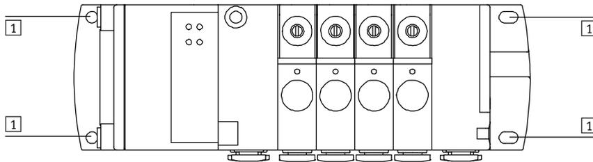
1 Taladros para el montaje con tornillos M3
