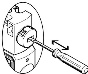
El accionamiento manual auxiliar se acciona presionando con un pasador o con un destornillador y regresa a su posición mediante reposición por muelle (la posición bloqueada se evita mediante la tapa ciega codificada).
