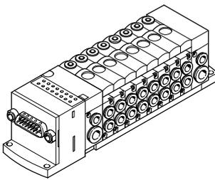
La señal se transmite hacia el terminal de válvulas a través de un cable multifilar preconfeccionado. De esta manera, la instalación resulta mucho más sencilla.
