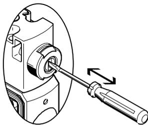
El accionamiento manual auxiliar se manipula presionando con un pasador o un destornillador y vuelve a su posición mediante la fuerza elástica del muelle.
