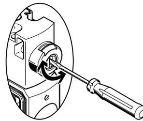
El accionamiento manual auxiliar se mantiene activo hasta que se desbloquea con un destornillador.
