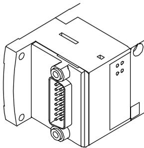
En esta variante de conexión eléctrica se controlan todas las válvulas de modo centralizado a través del conector de 15 y 26 contactos. La conexión eléctrica se encuentra en el lado izquierdo.
