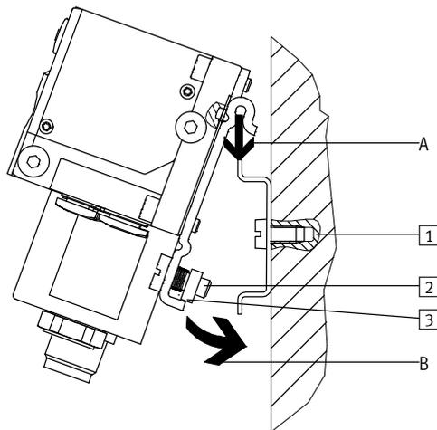
El terminal de válvulas CPV-SC se cuelga en el perfil DIN (ver flecha A). A continuación se presiona el terminal de válvulas y se fija mediante la pieza de bloqueo (ver flecha B).
