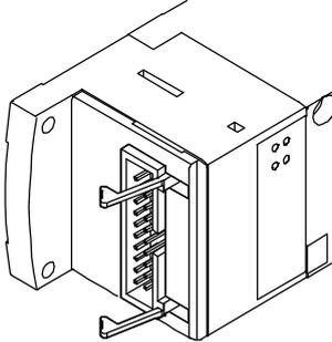
En esta variante de conexión eléctrica se controlan todas las válvulas de modo centralizado a través de un conector de 20 contactos. La conexión eléctrica se encuentra en el lado izquierdo.
