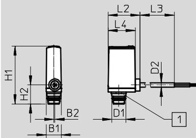
1 Conexión tipo clavija
