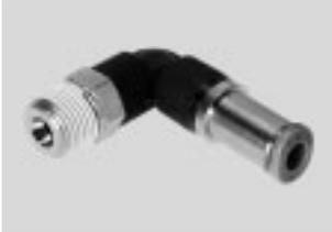
El racor rápido roscado bloquea el flujo de aire tras soltarse el tubo flexible. Para aplicaciones neumáticas con temperaturas de hasta 60 °C y presiones de hasta 14 bar. Diámetro exterior de los tubos flexibles de 4, 6, 8, 10 y 12 mm con rosca de conexión M5, R $\frac{1}{8}$  ... R $\frac{1}{2}$  y G $\frac{1}{8}$  ... G $\frac{1}{2}$ .
