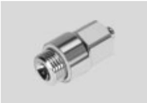
Racor de acero inoxidable para el uso en áreas expuestas a limpieza intensiva. Máxima clase de resistencia a la corrosión CRC4. Para aplicaciones neumáticas con temperaturas de hasta 120 °C y presiones de hasta 12 bar. Diámetro exterior del tubo flexible de 4, 6, 8 y 10 mm con rosca de conexión M5 y G $\frac{1}{8}$  ... G $\frac{3}{8}$ .
