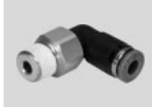
Racor rápido roscado con junta basculante, orientable en 360°. Cojinete de bolas para movimientos giratorios de hasta 500 rpm. Para aplicaciones neumáticas con temperaturas de hasta 60 °C y presiones de hasta 14 bar. Diámetro exterior de los tubos flexibles de 4, 6, 8, 10 y 12 mm con rosca de conexión M5, R $\frac{1}{8}$  ... R $\frac{1}{2}$  y G $\frac{1}{8}$  ... G $\frac{1}{2}$ .
