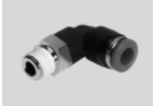
Gran variedad de racores rápidos roscados para aplicaciones neumáticas con temperaturas de hasta 80 °C y presiones de hasta 14 bar. Diámetro exterior de los tubos flexibles de 4, 6, 8, 10, 12, 16 y 22 mm con rosca de conexión de R1/8 ... R1/2 y G1/8 ... G3/4.
