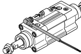
Colocar el conector tipo zócalo sobre el conector tipo clavija.
