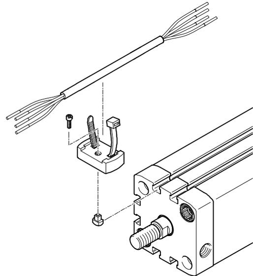
El kit de montaje garantiza el montaje plenamente fiable en ranuras T de Festo. La geometría del elemento de sujeción y de la tuerca deslizante coinciden exactamente con este sistema de montaje.
