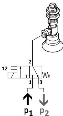
Para el funcionamiento con vacío utilizando la válvula de 3/2 vías (normalmente cerrada) debe conectarse el vacío en la conexión 3 (P2) y, por ejemplo, un silenciador de escape en la conexión 1 (P1). En ese caso, la posición normal cambia de normalmente cerrada a normalmente abierta.
