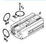
Las fuerzas y momentos admisibles indicados hacen referencia a una mordaza. Los valores indicados incluyen el brazo de palanca, fuerzas debido al peso de la pieza u ocasionadas por dedos de sujeción externos y, además, las fuerzas ocasionadas por la aceleración durante la ejecución del movimiento. Para calcular los momentos se debe tener en cuenta la posición 0 del sistema de coordenadas (ranura de guía de las mordazas).
