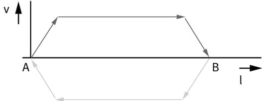
Perfil de movimiento ampliado para un funcionamiento más sencillo de la función de presión y sujeción: con regulación de velocidad y de fuerza
