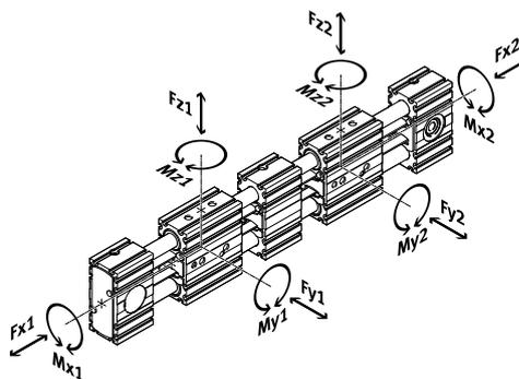
Si el eje está expuesto simultáneamente a varios de los momentos y fuerzas indicados más abajo, además de las cargas máximas admisibles deberá cumplirse la siguiente ecuación:
