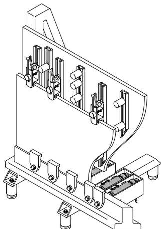
El músculo neumático permite sujetar fácilmente piezas a mecanizar grandes y difíciles de manipular, como placas, paredes o piezas laterales que se deben mecanizar mecánicamente (torneado, taladrado, fresado). Aquí juegan un papel fundamental las excepcionales características del músculo, como su gran fuerza con un diámetro pequeño, movimientos sin fricciones ni sacudidas, resistencia a la suciedad (virutas, abrasión) y, por último, su construcción hermética.
