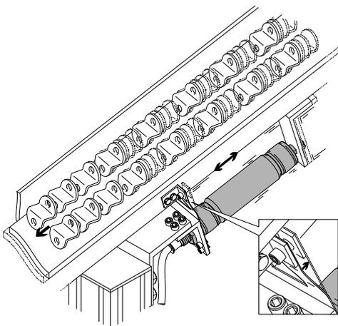
El músculo neumático es muy útil para transportar o alinear piezas. La amplitud y la frecuencia secuencial se pueden ajustar de forma fácil e independiente. Gracias a la flexibilidad que aporta el músculo, la velocidad de transporte de las piezas se puede configurar óptimamente para cada proceso de transporte.
