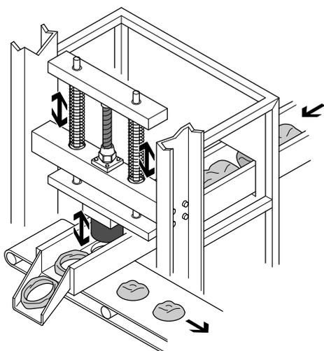
El músculo neumático permite alcanzar grandes tasas de ciclos. Por un lado, gracias a que pesa muy poco. Por el otro lado, porque no tiene piezas móviles (por ejemplo, no tiene émbolo). La estructura sencilla del músculo, pretensado mediante dos muelles, puede sustituir un complicado sistema de sujeción mediante palanca articulada con cilindros.
