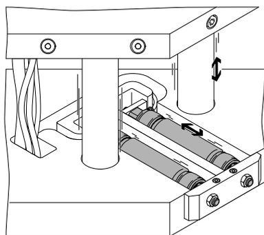
En los procesos de unión, como por ejemplo los que se producen en las máquinas de soldadura, el músculo neumático se encarga de sujetar durante el proceso de unión los componentes que se van a soldar. También en este ámbito de aplicación, la gran fuerza con un pequeño diámetro que posee el músculo es de gran utilidad.
