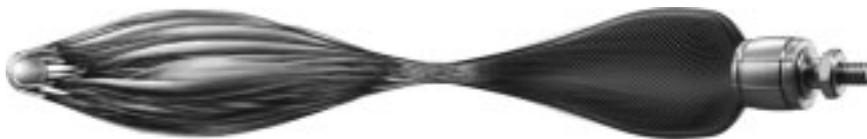
El músculo neumático es un actuador de tracción que imita la musculatura humana. Está compuesto por un tubo flexible contráctil y los empalmes. El tubo flexible contráctil está compuesto por una membrana de goma y un tejido interno de hilos de aramida. La membrana encierra herméticamente el medio de funcionamiento. Los hilos contribuyen a la robustez y a la transmisión de
