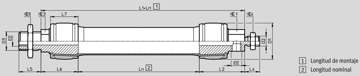
DMSP-...-AM-CM – Conexión neumática axial – Sin conexión, con rosca exterior
