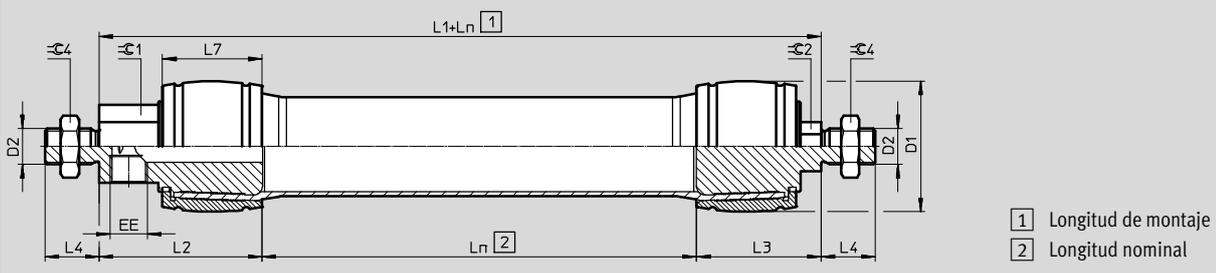
DMSP-...-RM-RM – Conexión neumática radial – Conexión neumática radial
