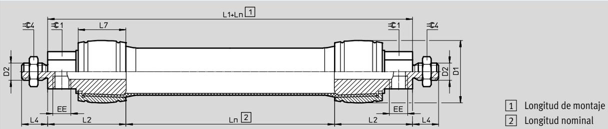
DMSP-...-AM-RM – Conexión neumática axial – Conexión neumática radial
