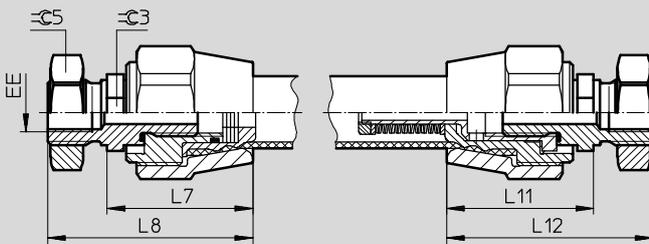
MAS...-ER/BR – Conexión neumática radial en un lado/en ambos lados
