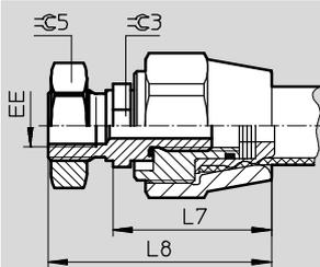
MAS...-ER/BR – Conexión neumática radial en un lado/en ambos lados
