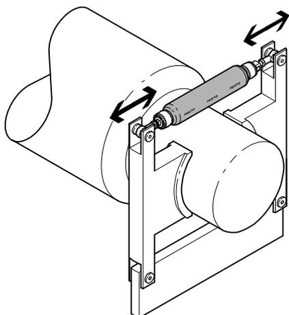
El músculo neumático es la referencia en aplicaciones que exigen reacciones muy rápidas. El sistema de parada de emergencia para rodillos exige reacciones rápidas y mucha fuerza inicial. De esta manera, se pueden prevenir potenciales situaciones de peligro para el usuario en caso de producirse un fallo.
