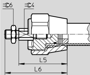
MAS...-EA/BA – Conexión neumática axial en un lado/en ambos lados
