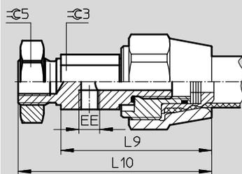
MAS...-ER/BR-EG/BG – Conexión neumática radial en un lado / en ambos lados, con barra roscada
