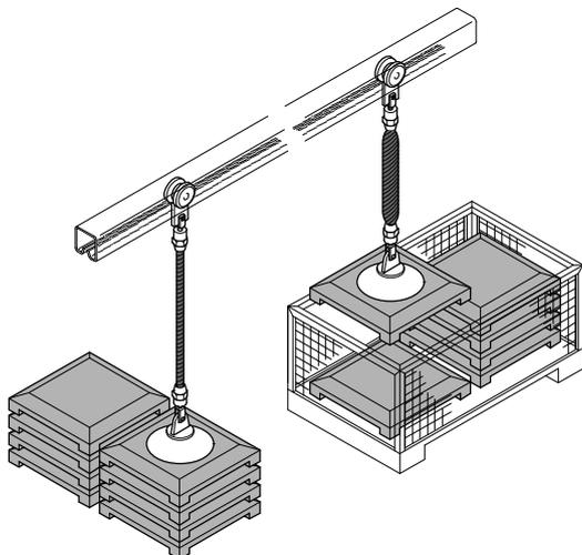
¿Desea utilizar posiciones intermedias? Con la regulación de la presión es muy fácil: con una válvula de palanca manual se aumenta o reduce la presión dentro del músculo neumático, de forma que las piezas pueden elevarse o descenderse hasta alturas indistintas. Con músculos de hasta 9 metros de largo es posible encontrar soluciones óptimas para muchas aplicaciones.
