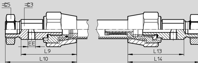
MAS...-EA/BA-EG/BG – Conexión neumática radial en un lado / en ambos lados, con barra roscada
