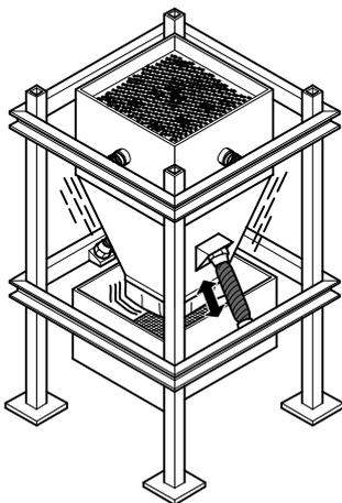
Durante el proceso de alimentación en depósitos o silos suelen producirse bóvedas de material que ocasionan problemas. En la práctica, para evitar que se forme una bóveda, se utilizan auxiliares de descarga, como dispositivos vibradores o sacudidores. Esta función puede realizarse utilizando el músculo neumático. La frecuencia se puede configurar por niveles hasta 150 Hz, y de manera independiente de la amplitud. De este modo se asegura un transporte continuo y fiable.
