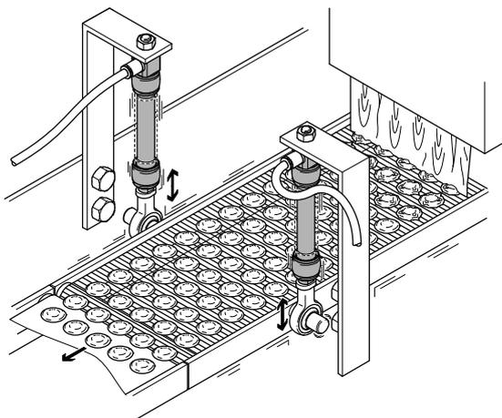
Para poder garantizar una distribución homogénea al colocar medios de recubrimiento viscosos sobre una sustancia portadora, se requiere una base vibratoria. En las carreras de menos de 1 mm, el músculo neumático permite alcanzar frecuencias secuenciales de hasta 150 Hz.
