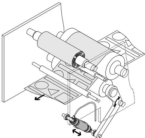
El músculo neumático es especialmente útil para la presión de contacto de los rodillos. La presión de contacto se puede modificar mediante la presión de funcionamiento. Su construcción sin componentes fijos hace que no se produzcan picos de fuerza. El músculo neumático es hermético y se puede separar de la alimentación de aire comprimido. Pese a ello, continúa cumpliendo con su cometido.
