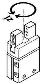
Momento de inercia de la masa de la pinza paralela respecto al eje central, sin dedos externos, sin carga.
