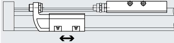
El tope KYC puede montarse en cualquier posición dentro de la carrera
