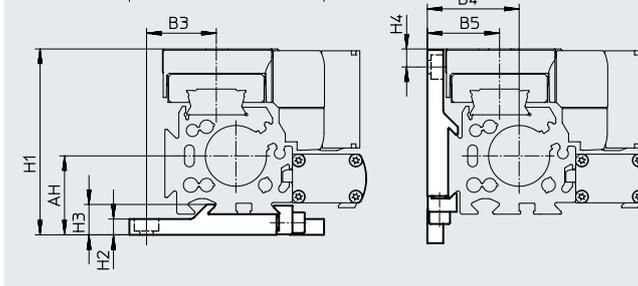
En combinación con la unidad de bloqueo, el soporte para amortiguador DADP y el módulo de posiciones intermedias DADM, la fijación para perfil únicamente puede montarse en la parte inferior.
