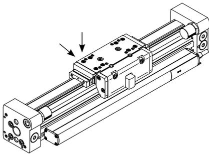
En combinación con el soporte para amortiguador DADP, únicamente pueden utilizarse las conexiones delantera y superior.
