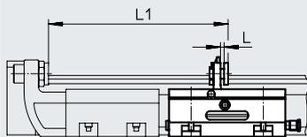
El módulo de posiciones intermedias DADM-DGC puede utilizarse en ambas direcciones.
