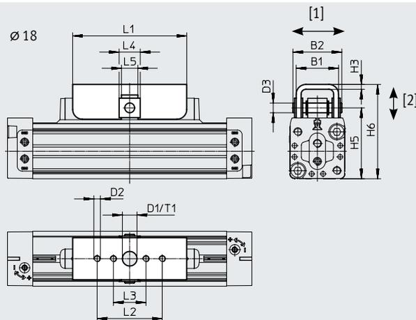
El compensador de par DARD-S tiene la misma interfaz que el compensador de par FKP en el actuador lineal DGP. En sistemas servoneumáticos utilizar el compensador de par DARD-M.
