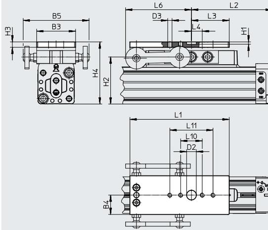
La placa adaptadora DAMF tiene la misma interfaz que el compensador de par FKP del actuador lineal DGP.
