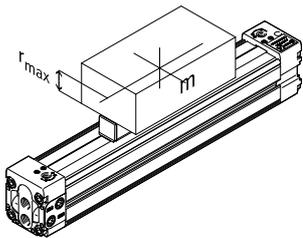
La amortiguación en las posiciones finales debe ajustarse de tal manera que no se produzcan choques. Si las condiciones de funcionamiento están fuera de los márgenes admisibles, debe recurrirse a los dispositivos adecuados (amortiguadores externos) y montarlos de tal manera que amortigüen la masa móvil en su centro de gravedad.
