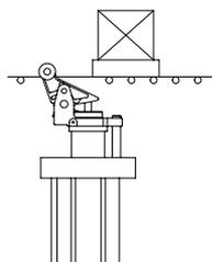
El émbolo se extiende por la fuerza del muelle o el aire comprimido, y la basculación de la palanca basculante evita la elevación del material transportado.
