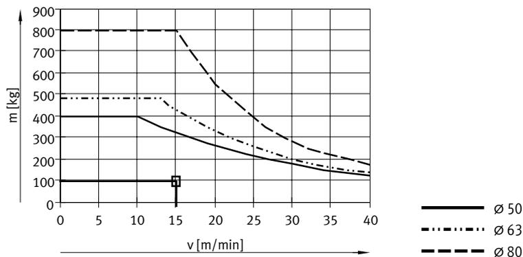
**2a. Cálculo de la fuerza de impacto máxima admisible si los palés avanzan hasta toparse con un palé que está situado junto al cilindro de tope**
