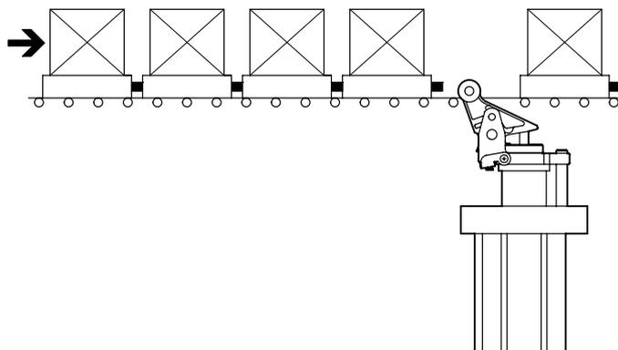
Con una velocidad de avance de 15 m/min, la masa máxima admisible para el DFST-50 es de 320 kg. Dado que la masa total de los 4 palés que avanzan hacia el cilindro de tope es de 400 kg, para realizar la separación deberá seleccionarse el cilindro de tope del tamaño inmediatamente superior.
