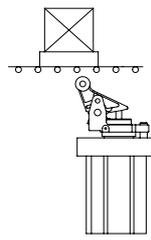
Detención suave de grandes masas mediante amortiguador hidráulico integrado en el vástago.
