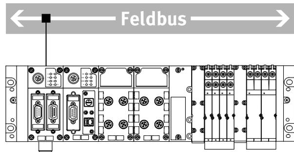
CODESYS V3 provided by Festo para el mejor terminal de instalación disponible: CPX-CEC como sistema remoto inteligente, con clase IP65/IP67, directamente en la máquina reduce los costes de instalación.
