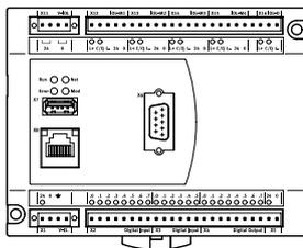
Compacto y con más funciones. Para el control de actuadores eléctricos y neumáticos en pequeñas tareas. Unidad autónoma o en soluciones de mecatrónica a través de CODESYS V3 provided by Festo.
