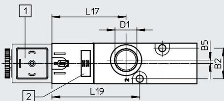
[1] Magnetspule Schnittstelle Form B/Form C
