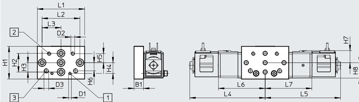
[1] Befestigungsbohrung für Baugröße 20
