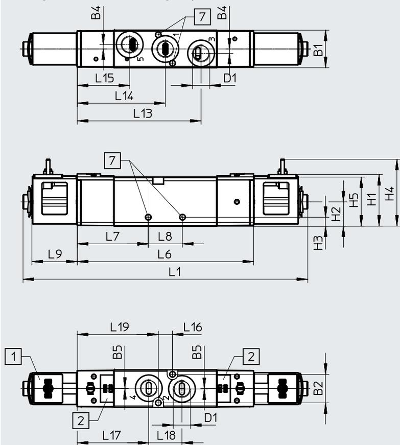
[1] Magnetspule Schnittstelle Form C
