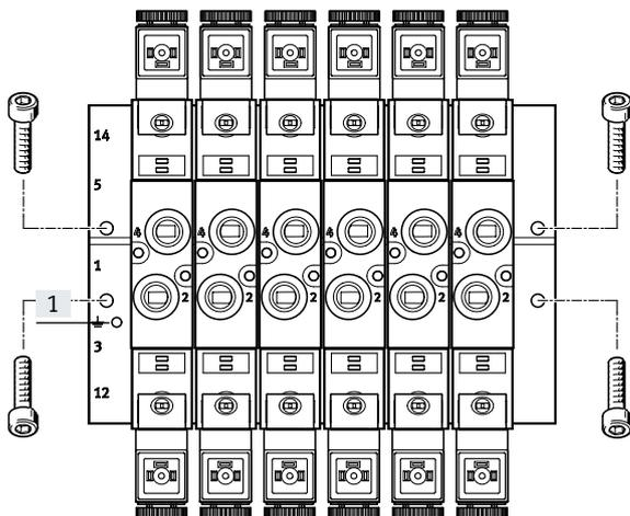
Robuste Wandmontage des Anschlussblocks mittels vier Durchgangsbohrungen.
