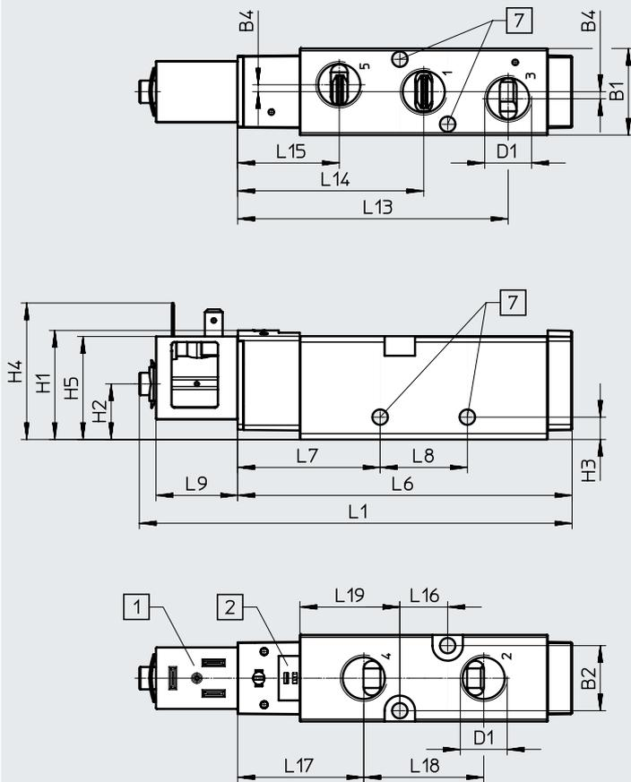
[1] Magnetspule Schnittstelle Form B
