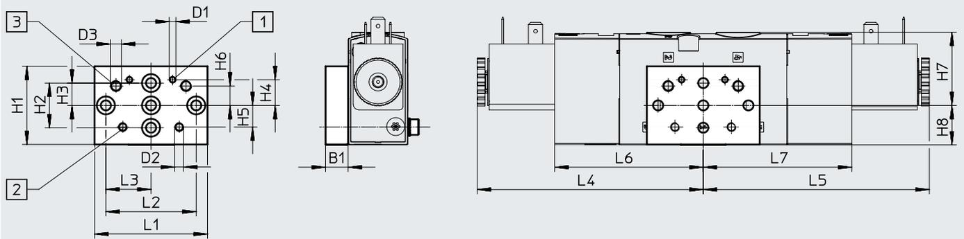
[1] Befestigungsbohrung für Baugröße 20
