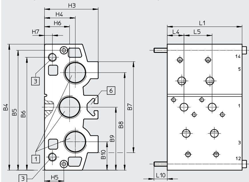
[1] Anschluss 1, 3 und 5: G3/4    [3] Anschluss 12 und 14: G1/8    [6] Profilnut IPM-08 System 8
