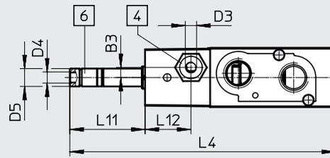
[1] Magnetspule Schnittstelle Form B/Form C
