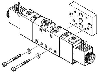
Zur Montage einzelner Ventile auf einer ebenen Fläche, z.B. Aluminium-Profilsysteme. Die Magnetventile sind mit zwei Durchgangsbohrungen zur Befestigung an der VAME-B10-20-W Wandbefestigung versehen.
