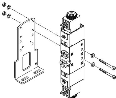
Zur Montage einzelner Ventile auf einer ebenen Fläche, z.B. Aluminium-Profilsysteme. Die Magnetventile sind mit zwei Durchgangsbohrungen zur Befestigung an der VAME-B10-...-A Fußbefestigung versehen.
