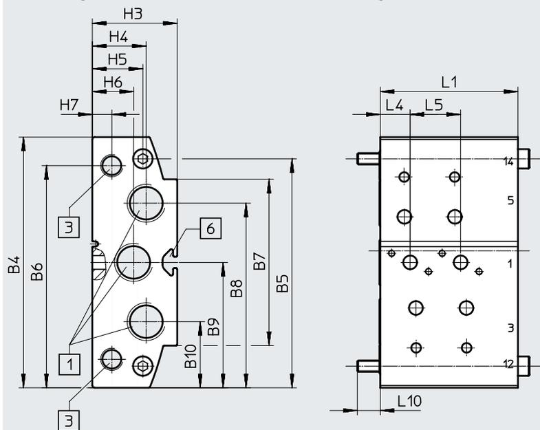
[1] Anschluss 1, 3 und 5: G3/8    [3] Anschluss 12 und 14: G1/8    [6] Profilnut IPM-05 System 5
