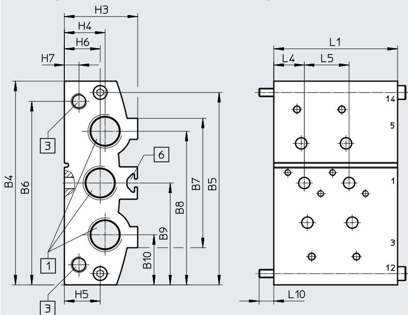
[1] Anschluss 1, 3 und 5: G1/2    [3] Anschluss 12 und 14: G1/8    [6] Profilnut IPM-05 System 5
