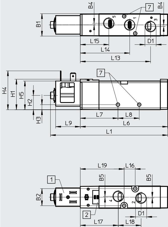
[1] Magnetspule Schnittstelle Form B
