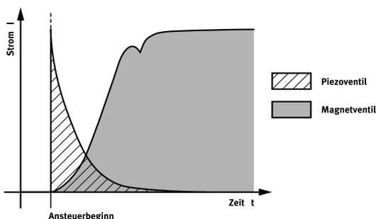
Im Vergleich zum Magnetventil brauchen Proportionalventile mit Piezotechnologie durch ihren kapazitiven Charakter so gut wie keine Energie zur Wahrung eines aktiven Zustandes. Das Piezoventil arbeitet ähnlich wie ein Kondensator: Zum Aufladen der Keramik benötigt es nur am Anfang Strom. Zum Halten des Zustandes ist keine weitere Energie notwendig. Dadurch findet auch keine Eigenerwärmung der Ventile statt.
