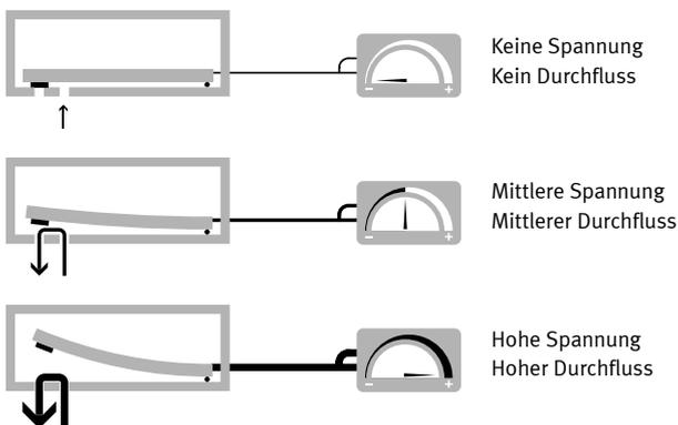
Für eine proportionale Regelung wird der Piezoaktor mit einer variablen Spannung angesteuert.
