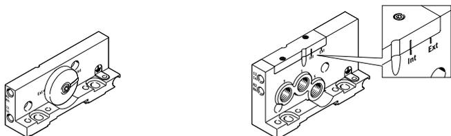
Liegt der Versorgungsdruck der Insel zwischen 3 und 8 bar, so kann interne Steuerluftversorgung gewählt werden. In diesem Fall wird die Steuerluftversorgung durch eine interne
