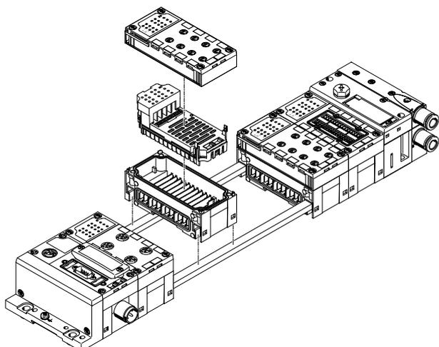
Die CPX-Module werden mit Zugankern mechanisch miteinander verbunden. Die Befestigung erfolgt mit nur zwei Schrauben in den Endplatten für die gesamte Einheit.
