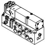
Für von der Ventilinsel weiter entfernte Aktuatoren können auch Ventile auf Einzelanschlussplatten eingesetzt werden. Die Ventile werden mit einer aus Aluminium-Druckguss bestehenden Einzelanschlussplatte verschraubt.
