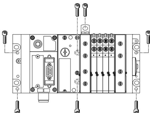
Die MPA-L Ventilinsel wird mit vier M4- und zwei M6-Schrauben oder mit sechs M6-Schrauben auf der Befestigungsfläche angeschraubt. Die Montagebohrungen befinden sich an der linken und rechten Endplatte und im Pneumatik-Interface. Zusätzlich stehen optionale Befestigungswinkel zur Verfügung.
