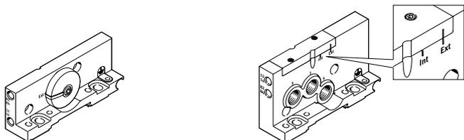
Liegt der Versorgungsdruck (an der rechten Endplatte) unter 3 bar oder über 8 bar, so muss die MPA-L Ventilinsel mit externer Steuerluftversorgung betrieben werden. Hierzu wird die Steuerluftversorgung über den Anschluss 12/14
