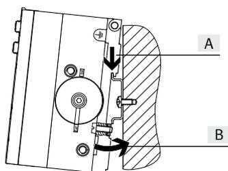
Die MPA-L Ventilinsel wird in die Hutschiene eingehängt (siehe Pfeil A). Danach wird die MPA-L Ventilinsel auf die Hutschiene geschwenkt und durch das Klemmstück befestigt (siehe Pfeil B).
