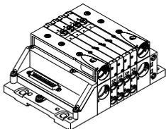
Der Signalfluss von der Steuerung zur Ventilinsel erfolgt über ein mehradriges vorkonfektioniertes oder selbstkonfektioniertes Kabel zum Multipolanschluss. Dadurch wird der Installationsaufwand erheblich reduziert.
