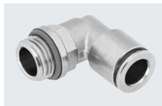
Vollmetallsteckverschraubung aus Messing, chemisch vernickelt. Hohe Korrosionsbeständigkeit KBK3 und Chemikalienresistenz. Für Pneumatikanwendungen mit einem Temperaturbereich bis 150 °C und einem Druckbereich bis 20 bar. Schlauch-Außen- $\varnothing$  4, 6, 8, 10, 12 und 14 mm mit Anschlussgewinde M5, M7 und G1/8 ... G1/2.
