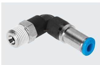
Steckverschraubung sperrt Luftstrom nach dem Lösen des Schlauchs. Für Pneumatikanwendungen mit einem Temperaturbereich bis 60 °C und einem Druckbereich bis 14 bar. Schlauch-Außen- $\varnothing$  4, 6, 8, 10 und 12 mm mit Anschlussgewinde M5, R1/8 ... R1/2 und G1/8 ... G1/2.
