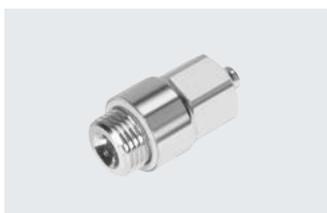
Edelstahlverschraubung für den Einsatz in reinigungsintensiven Bereichen. Höchste Korrosionsbeständigkeit KBK4. Für Pneumatikanwendungen mit einem Temperaturbereich bis 120 °C und einem Druckbereich bis 12 bar. Schlauch-Außen- $\varnothing$  4, 6, 8 und 10 mm mit Anschlussgewinde M5 und G1/8 ... G3/8.
