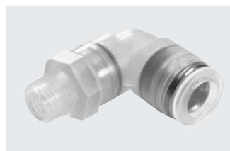
Polypropylenverschraubung für den Einsatz bei Anwendungen mit extremen Medieneinflüssen. Für Pneumatikanwendungen mit einem Temperaturbereich bis 60 °C und einem Druckbereich bis 10 bar. Schlauch-Außen- $\varnothing$  4, 6, 8, 10 und 12 mm mit Anschlussgewinde von R1/8 ... R1/2.
