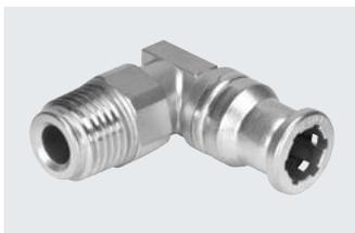
Edelstahlsteckverschraubung. Höchste Korrosionsbeständigkeit KBK4 und Chemikalienresistenz mit Zulassung in der Nahrungsmittel- und Verpackungsindustrie. Für Pneumatikanwendungen mit einem Temperaturbereich bis 120 °C und einem Druckbereich bis 10 bar. Schlauch-Außen- $\varnothing$  4, 6, 8, 10, 12 und 16 mm mit Anschlussgewinde M5 und R1/8 ... R1/2.
