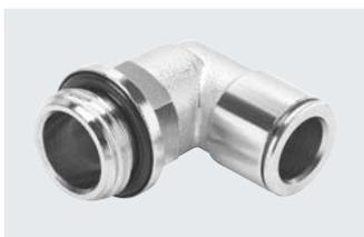
Metallsteckverschraubung zum attraktiven Preis für Pneumatikanwendungen mit einem Temperaturbereich bis 70 °C und einem Druckbereich bis 16 bar. Schlauch-Außen- $\varnothing$  3, 4, 6, 8, 10, 12 und 14 mm mit Anschlussgewinde M5, M7 und G1/8 ... G1/2.
