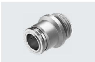
Edelstahlsteckverschraubung. Höchste Korrosionsbeständigkeit KBK4 und Chemikalienresistenz. Für Pneumatikanwendungen mit einem Temperaturbereich bis 150 °C und einem Druckbereich bis 16 bar. Schlauch-Außen- $\varnothing$  4, 6, 8, 10 und 12 mm mit Anschlussgewinde M5, M7 und G1/8 ... G1/2.
