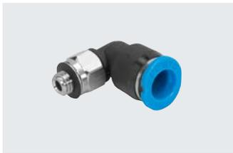
Kleinbauende Steckverschraubung für höchste Packungsdichte auf kleinstem Einbauraum. Für Pneumatikanwendungen mit einem Temperaturbereich bis 80 °C und einem Druckbereich bis 14 bar. Schlauch-Außen- $\varnothing$  2, 3, 4 und 6 mm mit Anschlussgewinde M3, M5, M6, M7, R1/8 und G1/8.
