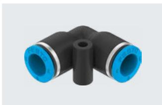
Preisgünstige Steckverschraubungen für Pneumatikanwendungen mit einem Temperaturbereich bis 60 °C und einem Druckbereich bis 8 bar. Schlauch-Außen- $\varnothing$  3, 4, 6, 8, 10, 12, 14 und 16 mm mit Anschlussgewinde M3, M5, M7 und R1/8 ... R1/2.
