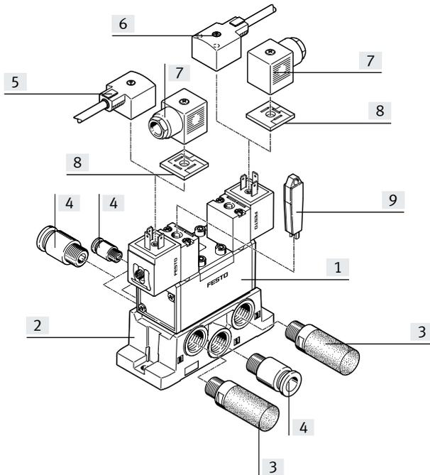
Magnetventil mit Zentralstecker M12 3-polig
