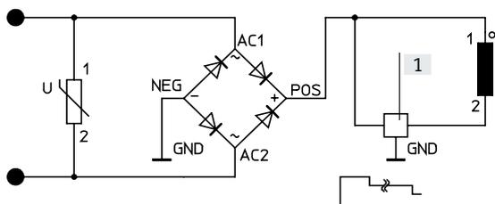
M12x1 – Anschlussbelegung am Ventil
