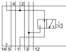
Vertikaldrucksperrplatte, zum Sperren von Kanal 1 und Kanal 14 vor einem Ventil.
