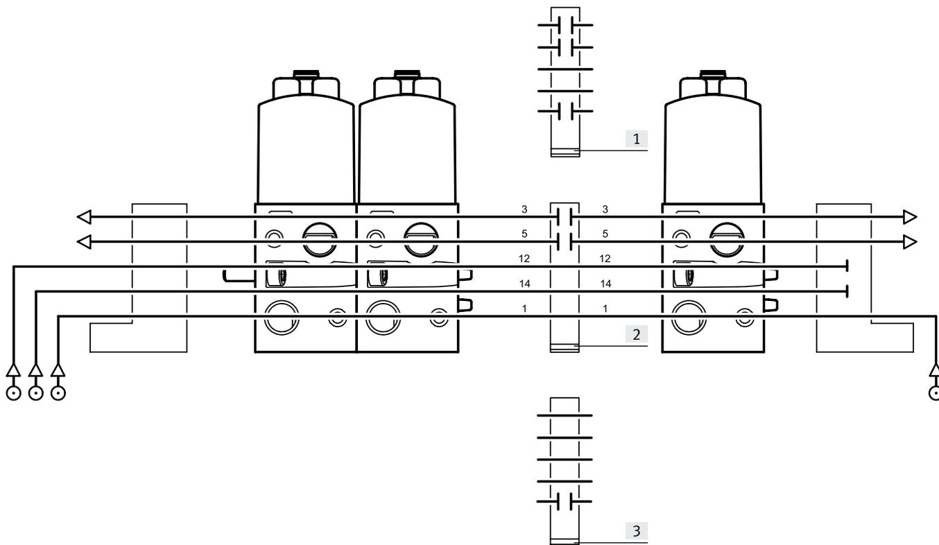
[1] Druckzonenrennung in Kanal 1, 3 und 5. Druckeinspeisung und Entlüftung erfolgt für jede der beiden Druckzonen über die jeweilige Endplatte. Steuerluftversorgung erfolgt gemeinsam über die linke Endplatte.
