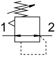
Der Druckregler, ermöglicht das manuelle Einstellen eines bestimmten Druckes in dem geregelten Anschluss vor oder auch nach dem Ventil.
