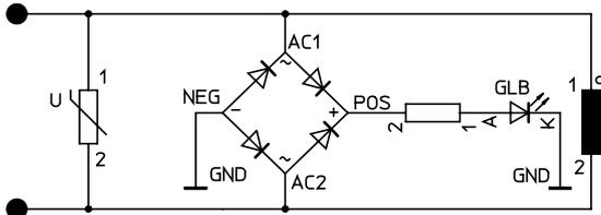
M12x1 – Anschlussbelegung am Ventil
