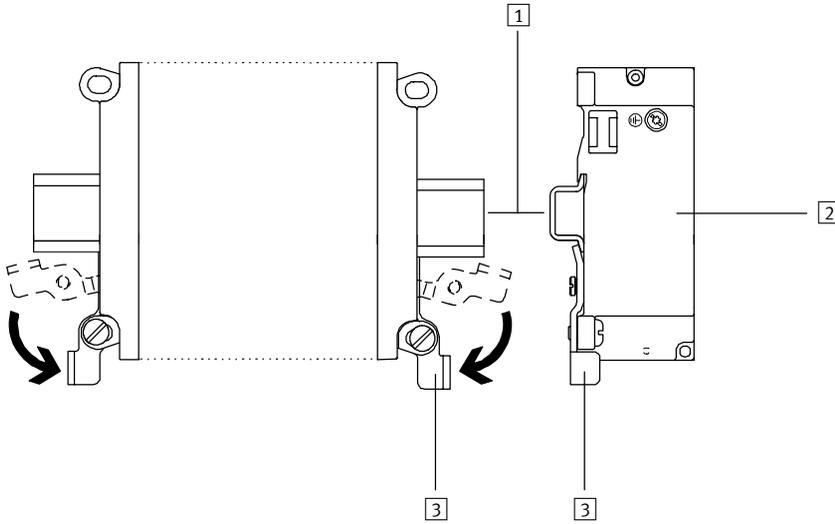
将阀岛固定于 H型导轨后用摆动杆固定。
