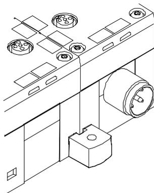
对于长度较长的阀岛，还需加装一个（适用于 CPX 电终端的）辅助安装支架，该附件可以被固定在任意一个模块上。
