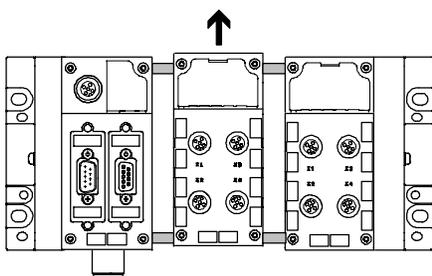
由于采用了开放式结构，因此在不进行整体拆卸的情况下就可对互连模块进行更换。通过紧固杆扩展组件 CPX 可在现有模块的基础上再加增一个模块。
