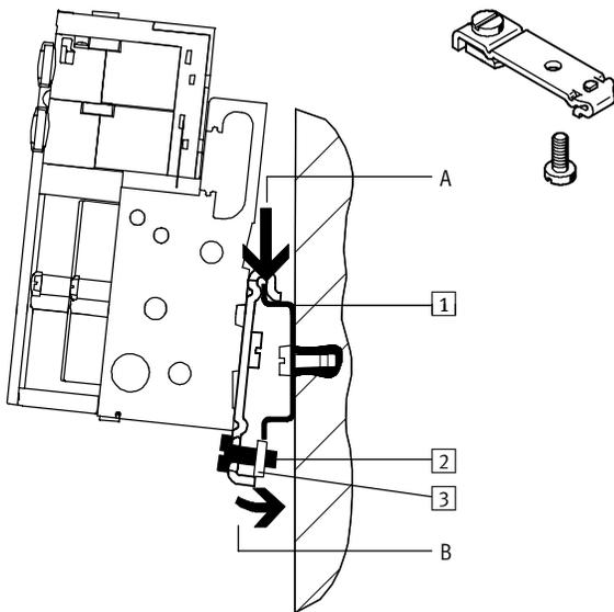
将阀岛挂在 H型导轨上（参见箭头 A）。此时阀岛可侧向摆动，然后用夹紧元件将该端固定（参见箭头 B）。
