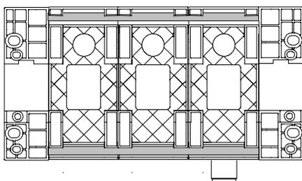
CPX 模块间的机械连接是通过两根紧固杆来实现的。只通过端板上的两个螺钉就可完成整个单元的安装。
