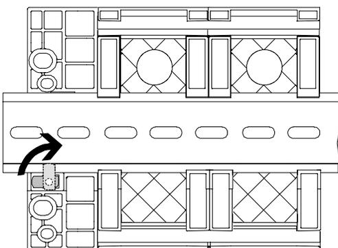
H型导轨安装件被压入 CPX 模块的背面，然后模块通过 H型导轨安装件再与导轨连接。
