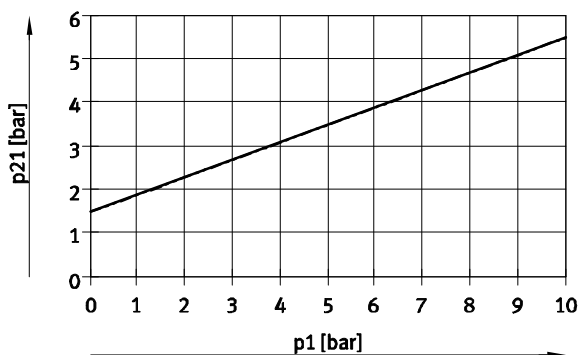
Pilotaje p_{21} en función de la presión de funcionamiento p_1
