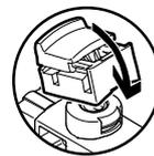
Encajar el accionamiento manual auxiliar con bloqueo sobre la válvula servopilotada. Posteriormente, se puede accionar la tapa del accionamiento manual auxiliar con enclavamiento sin herramienta. En el menú de selección Accionamiento manual auxiliar del configurador de terminales de válvulas, se pueden encargar válvulas equipadas con una tapa ciega (código Y).
