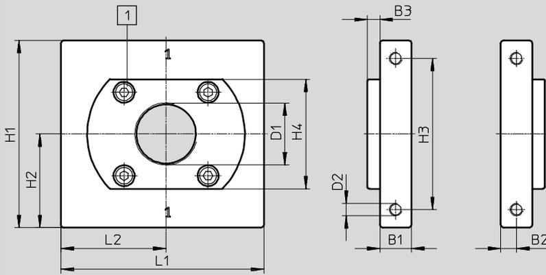
1 Tornillo cilíndrico M10x30
