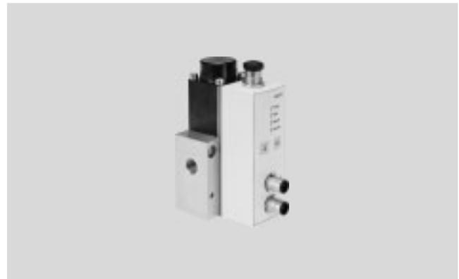
El regulador de presión proporcional VPPL determina la presión de salida del regulador eléctrico de presión PREL mediante un sensor de presión integrado y la compara internamente con el valor nominal. En caso de constatarse diferencias, el VPPL pilota el regulador del PREL hasta que la presión de salida haya alcanzado el valor nominal. En la posición básica (sin valor de referencia) la presión de
