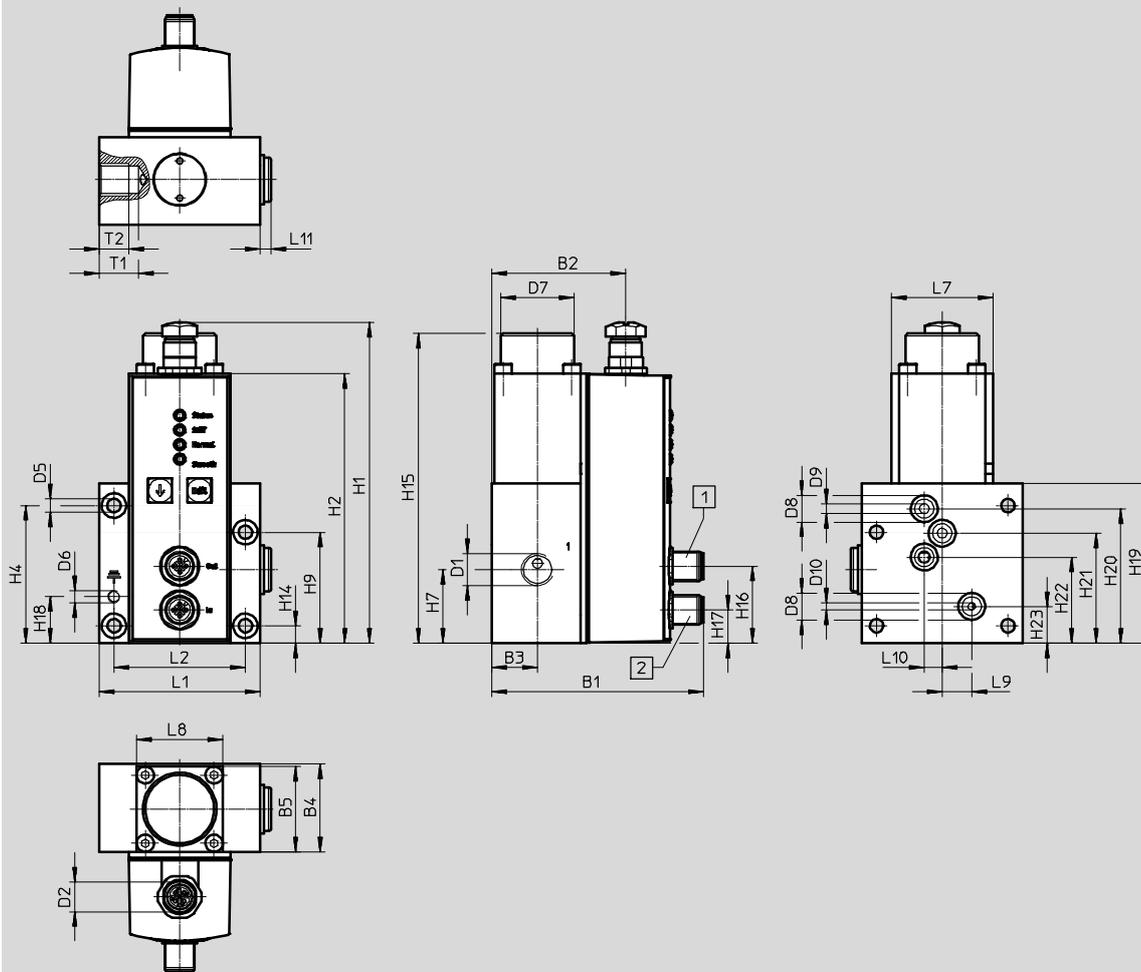
1 Conexión de salida OUT
