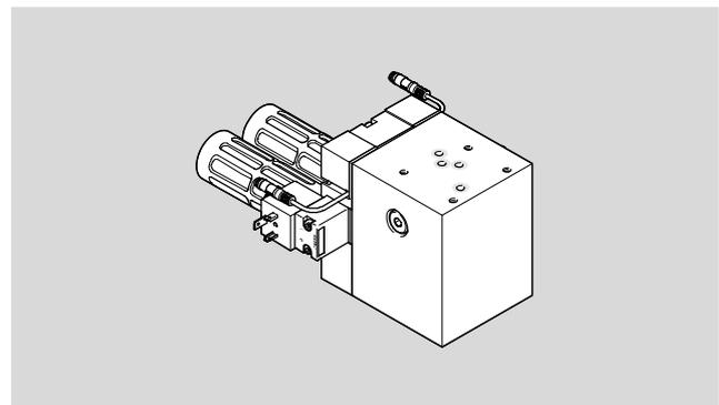
La válvula de desconexión de dos canales PAHL sirve para desconectar el aire de pilotaje del regulador eléctrico de presión servopilotado neumáticamente PREL-186. Para ello, la PAHL está equipada con dos válvulas de asiento 2/2 que se accionan mediante las electroválvulas servopilotadas. Para la supervisión de la posición de conmutación de las válvulas de asiento se han integrado sensores de proximidad. La función de seguridad se obtiene mediante un
