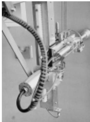
Radiación de hasta 4 Sievert/hora y la utilización de agua desalinizada en un manipulador para el desmontaje de depósitos de presión y escudos térmicos de reactores nucleares.
